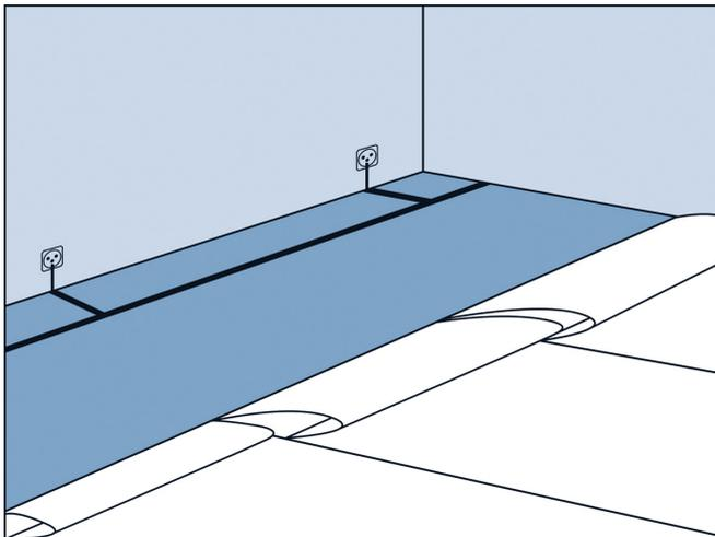
**Achtung: Nur Beläge mit horizontal leitfähiger Rückenbeschichtung verwenden. Kupferband kann sich im Bodenbelag durchzeichnen.**
