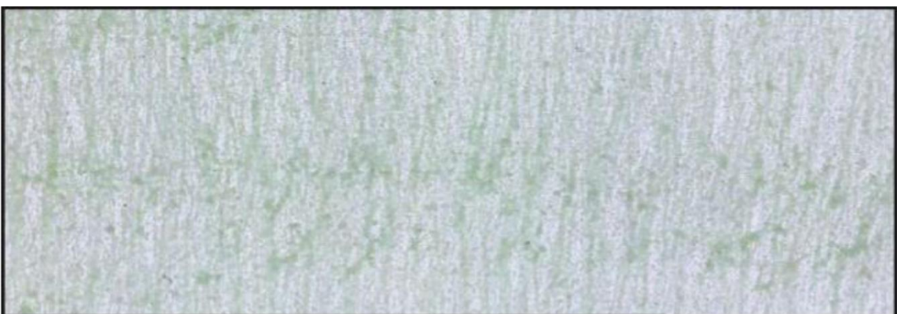
Kleberschicht „ korrekt “. Die Klebermenge ist 21 trockene Gramm, bei einer optimalen Benutzung von 80 – 100 % Deckung. Bei porösen, saugenden und schwierigen Materialien empfiehlt der Hersteller eine zweite Kleberschicht in dieser korrekten Ausführung.
