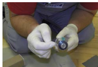
3. Bei 4 mm Bohrung ohne Nadel einsetzen
