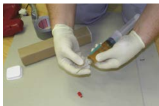
5. Für kleinere Bohrdurchmesser Nadel aufsetzen
